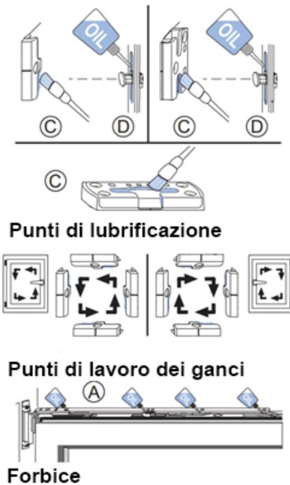
La figura 1 mostra i possibili punti di lubrificazione che dovrebbero essere lubrificati almeno una volta all'anno.
