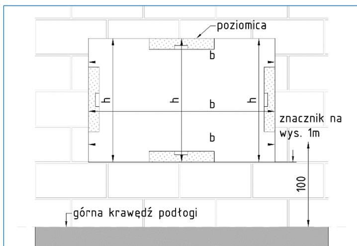
Fig. 2 Metodo di misurazione dell'apertura della finestra
