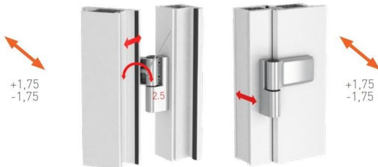
Fig.92 Regolazione della pressione della guarnizione.
